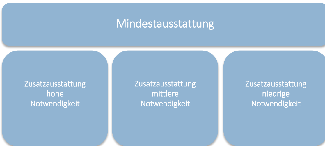
Abb. 7: Baukastenprinzip von Mobilstationen
