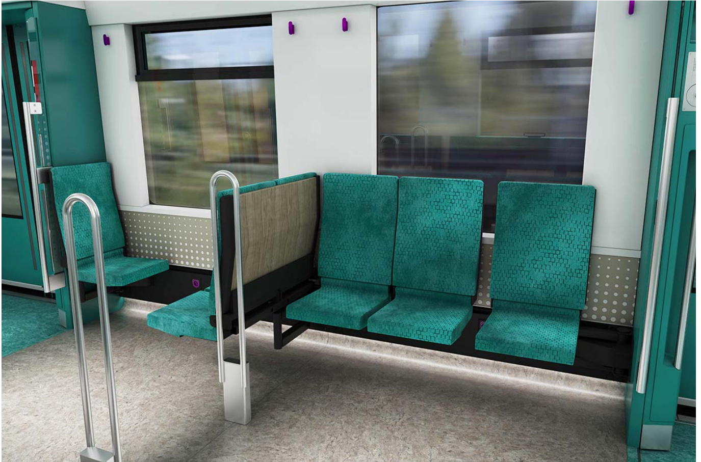
Flexmodule sind Vis-à-vis-Sitze, die bei Bedarf umgeschwenkt oder eingefahren werden können. (© Alstom / Advanced & Creative Design)
